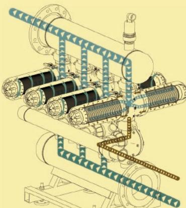
**FASE DE FILTRADO:** El agua al entrar en el filtro se encuentra con la Hélice originando un movimiento helicoidal centrífugo que aleja las partículas de los discos.
